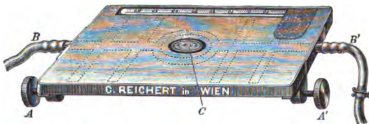
Fig. 16. Heizbarer Objecttisch, nach LÖWIT, von C. REICHERT, \frac{1}{3} nat. Grösse.
